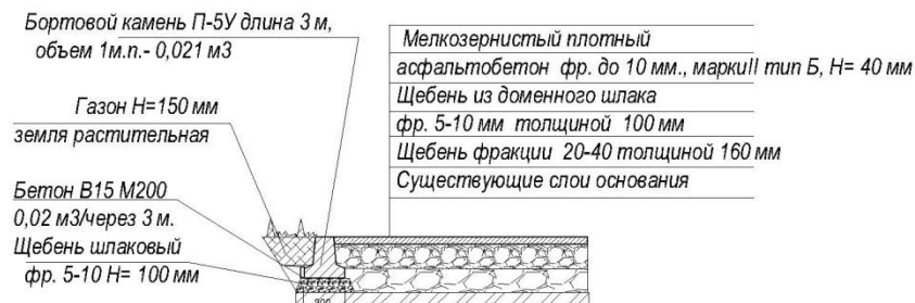
Схема 4.1 Конструкция покрытия тротуара. Примыкание к газону
